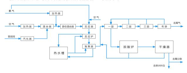
气相法白炭黑主要是通过化学气相沉积法,又称热解法、干法或燃烧法制得。其原料一般为四氯化硅、空气和氢气,空气和氢气分别经过冷却脱水、硅胶干燥、除尘过滤后送入合成水解炉。将四氯化硅原料送至蒸发器中加热蒸发,并以干燥、过滤后的空气为载体,送至合成水解炉。四氯化硅在高温下气化后,与一定量的氢和空气在高温下进行水解;此时生成的气相法白炭黑颗粒极细,与气体形成气溶胶,不易捕集,故使其先在聚集器中聚集成较大颗粒,然后经旋风分离器收集,再送入脱酸炉,用水蒸气和空气吹洗气相法白炭黑至pH值为3.8以上即为亲水白炭黑,用有机基团取代白炭黑表面羟基中氢使白炭黑能够浓于有机溶剂即为疏水气相法白炭黑。
