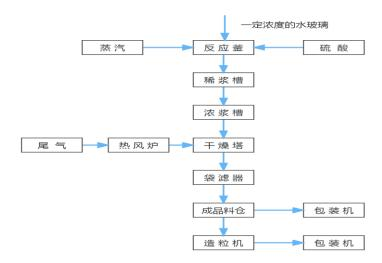
沉淀法白炭黑利用硅酸钠与硫酸反应制得,液体水玻璃加水调节到20%-30%的浓度送入下一道工序进行合成,在合成釜内先加入一定量的水和水玻璃,在80-90℃温度下,同时加入硫酸和水玻璃并搅拌而生成白炭黑浆料,将浆料进入压滤机进行压滤,并用清水洗去其中的硫酸钠再进入打浆槽制得浓浆,用炭黑尾气燃烧产生的烟气与空气热交换,得到500℃左右热风将经过雾化机雾化浓浆干燥为白炭黑粉末,用袋滤器收集后进行包装,根据需求,可将粉末状的白炭黑进行造粒,变成块状白炭黑进行包装销售。
