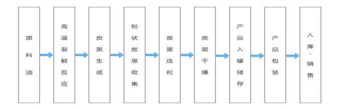
炭黑反应生成过程炭黑生产的核心是炭黑反应炉,燃料与空气先在反应炉的燃烧室完全燃烧产生高温烟气,并高速流经喉管。在喉管处,原料油由喷枪喷入反应炉,高温裂解反应生成炭黑及尾气。在此过程中,通过控制风、油配比、添加剂和 - }冷装置来控制生成炭黑品种。炭黑反应生成过程的关键技术是反应的温度、时间及取向控制。反应温度的高低及反应时间的长短主要影响炭黑的性质,反应的取向决定原料油生成炭黑反应转化比例的高低。
